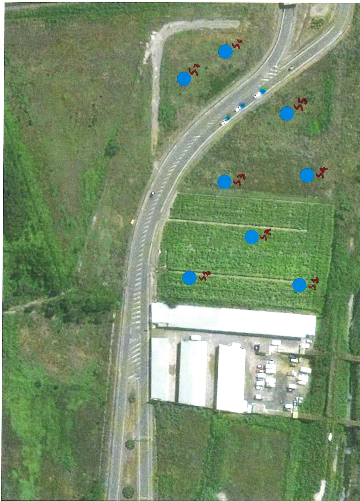
- UBICAZIONE DEI SONDAGGI AMBIENTALI ESEGUITI NELL'AREA IN OGGETTO IN CUI SONO STATI PRELEVATI E ANALIZZATI IN LABORATORIO SPECIALIZZATO CAMPIONI DI TERRENO E ACQUA
